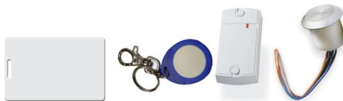
Рис. 37. Внешний вид Proximity-карт и брелоков и возможные варианты их считывателей
